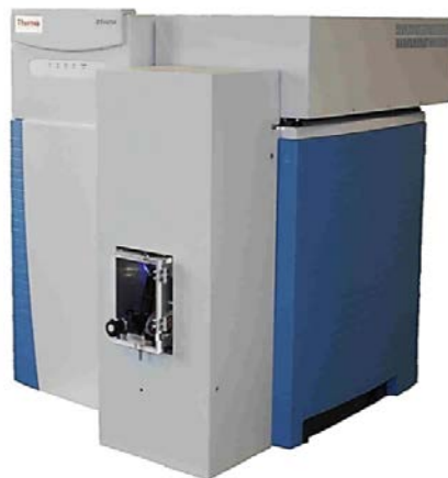
图 1 TransMIT AP-SMALDI 10 质谱成像仪
